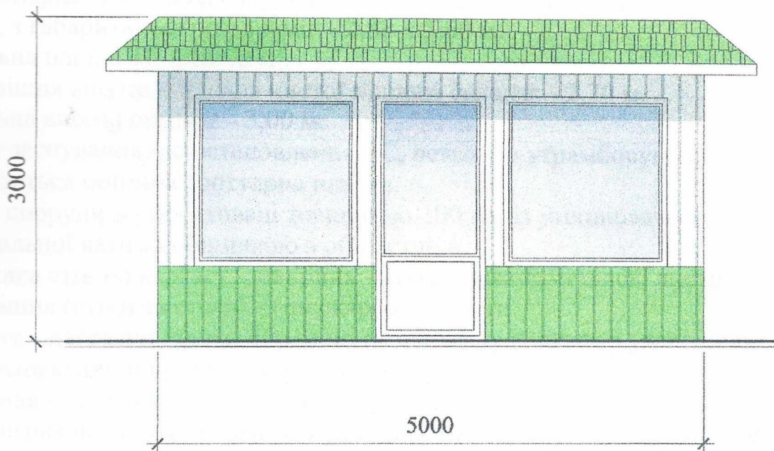
Бічний фасад ТС М 1:50
